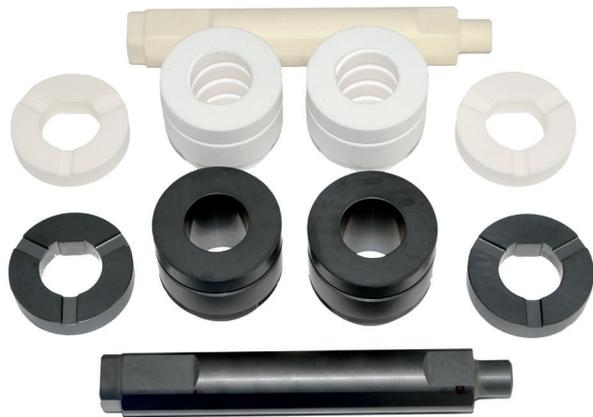
Per servizi meno gravosi sono disponibili boccole rotanti in Al<sub>2</sub>O<sub>3</sub> + PTFE, albero e ralle in Al<sub>2</sub>O<sub>3</sub> al 99.7 %. Per i servizi più critici vengono montate boccole rotanti e le ralle reggispinta in carburo di silicio (SiC).
